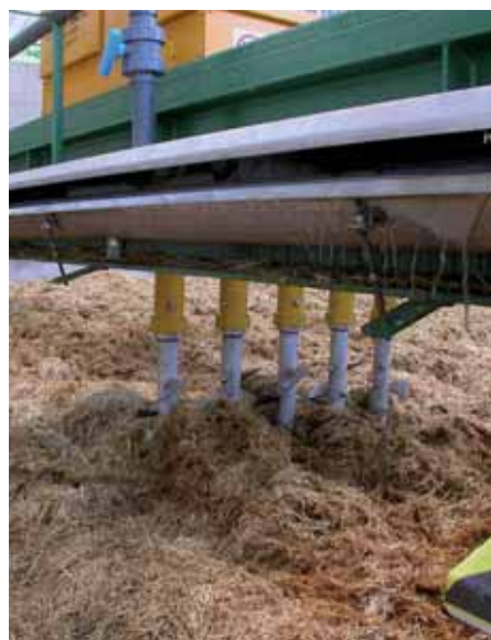
▼ Fondamentale il lavoro svolto dalle coclee: la foggia particolare e il loro movimento assicurano un rimescolamento continuo e peculiare della lettiera, che ad un passaggio viene portata dal basso verso l'alto e al passaggio successivo dall'alto verso il basso. Contemporaneamente dalle coclee viene insufflata dell'aria nella biomassa. Quando c'è lo spandimento del liquame le coclee si sollevano, permettendo così un agevole scorrimento del carroponete.
