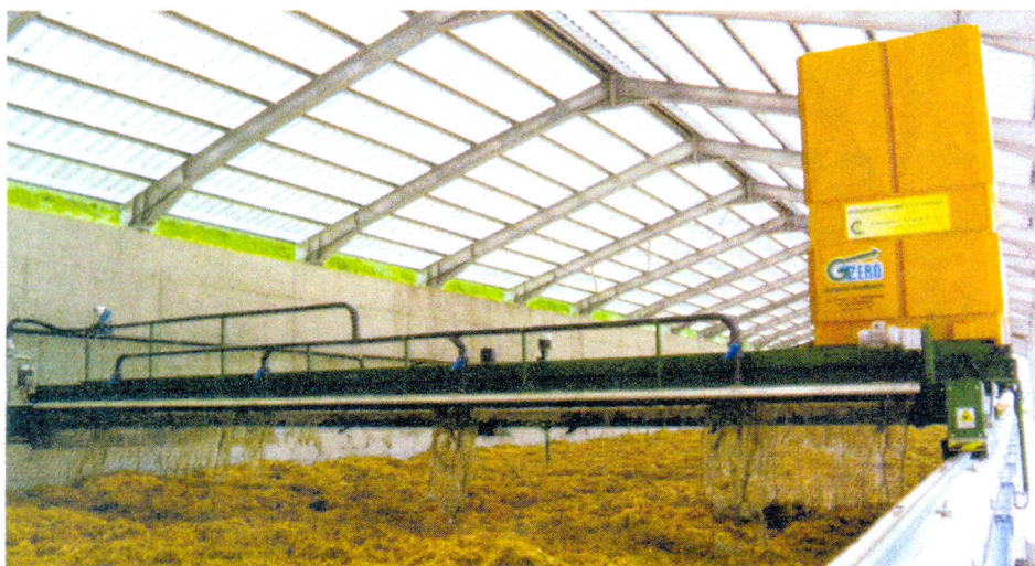
● La fase di spandimento dei liquami sul letto di biomassa ligno-cellulosica.
